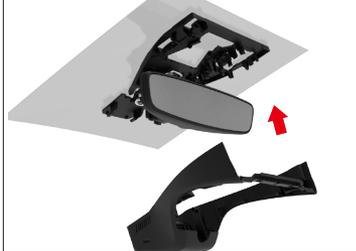
②将DVR主体往后扣紧卡扣,确保安装牢固。
